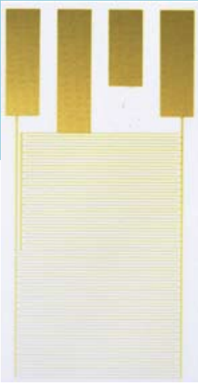
In Dünnschichttechnik gefertigter Sensor, der von der Testo AG (Lenzkirch) bereitgestellt wurde und erfolgreich zur Herstellung von Immunsensoren genutzt wird (Foto: FH Neubrandenburg)
